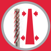
FLUTE À GÉOMETRIE VARIABLE PERÇAGE PLUS RAPIDE
