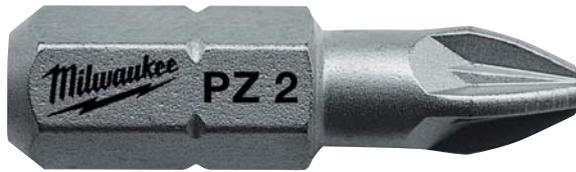
Empreinte forgée pour s'insérer parfaitement dans la tête de vis et supprimer les dérapages. Traitement extra-durcisseur à 870°C. Résultat d'une qualité extra-dure de 60 HRC. Les embouts Milwaukee® durent vraiment plus longtemps et offrent une très grande résistance à l'usure.
