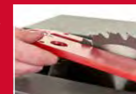
Cliquets anti-recul empêchant le matériel de se retourner contre l'opérateur
